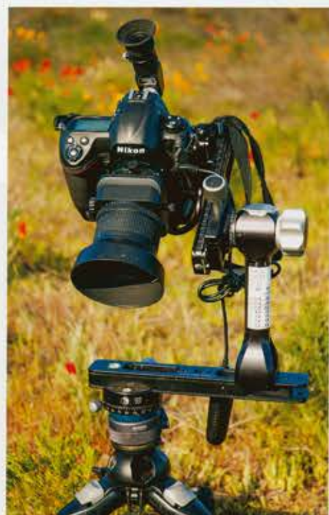
Ausrüstung für die hier gezeigten Panoramen: Nikon D3X mit Drahtauslöser, Winkelsucher und Tilt-/Shift-Objektiv, Tragesystem aus Manfrotto-Stativ, Magfiber Pro 055MF3, Nivellierplatte Novoflex MagicBalance, Panoramakopf Really Right Stuff PG-02-Pro-OPP, Winkelschiene: Kirk BL-D3.
